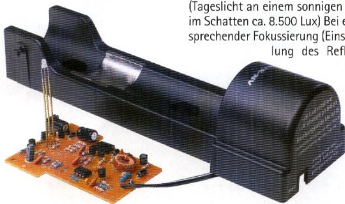
Im Halter ist die Ladeelektronik mit Erhaltungsladung integriert
